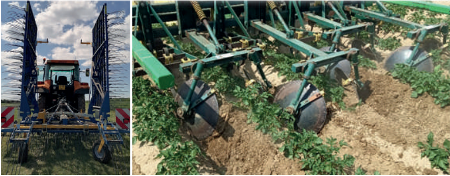
Outils de désherbage en pommes de terre – À gauche, herse-étrille Treffler ; à droite, butteuse à disques.
