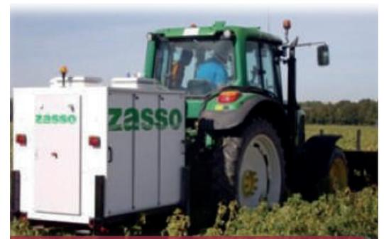
> Équipement Xpower de Zasso avec un générateur électrique à l'arrière du tracteur, relié au caisson « applicateur » situé à l'avant
