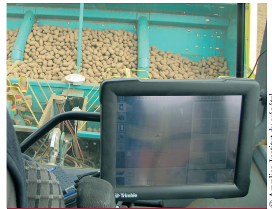
> Un mouchard en GPS RTK pour évaluer la précision de plantation..
